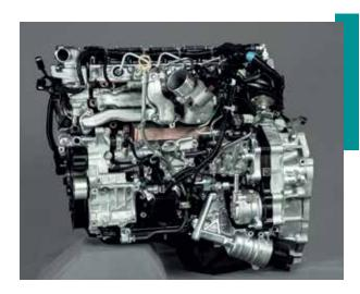
El modelo NHR EVI cuenta con el nuevo motor 4JZ1-TCS de 150 caballos de potencia (110 kw) y 38 kg-m (375 N.m) de torque, gracias a sus 2.999 CC se reduce el consumo de combustible y se mantiene el torque plano, que va desde los 1.280 RPM hasta los 2.800 RPM.
